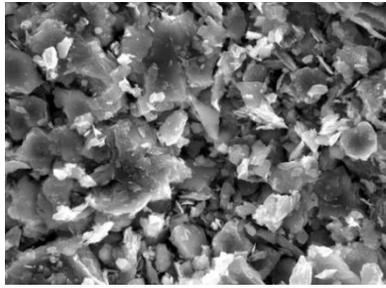
TC400은 평균입경 d(0.5)가 13.0 $\mu$ m 이하의 제품으로 흡유량 및 점도를 최소화한 제품입니다.
