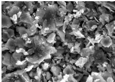
TA400은 평균입경  $d(0.5)$ 가  $13.0\mu\text{m}$ 의 제품으로 낮은 마모도 및 소성 수축이 적은 제품으로 플라스틱 및 내부 코팅 용도로 많이 사용되고 있습니다.
