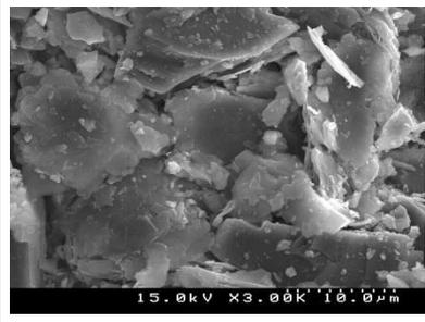
TA4000은 평균입경 d(0.5)가 6.5 $\mu$ m의 제품으로 기술 집약적인 다단 분급을 통해 고른 입자 분포를 가지며 백색도가 우수한 제품으로, bulk density가 낮아 충진율을 높일 수 있습니다.
