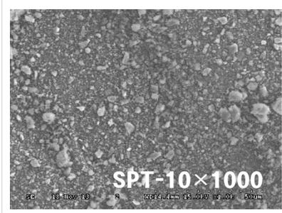
SPT-10은 SPN-10을 stearic acid로 표면 처리하여, 유동성 및 수분 침투의 저항성을 극대화한 제품이며, Top Cut이 10 $\mu$ m 이하로 관리되는 제품으로 입니다.
